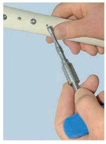
2 Select the corresponding Relief Cutter (CES-RC-01/14 and attach to the Straight or Offset "T" handle (CES-1-03/04 or alternatively to the Power Adaptor (CES-1-08).
