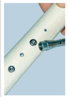
2 Select the corresponding Screw Extractor Shaft (CES-SE-01/14).
